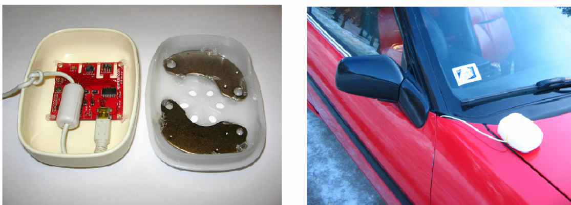
2.2. att. Magnētiska meteo datu ieguves iekārta uz sensoru moduļa USB Weather Board v2 bāzes. Pa kreisi - konstrukcija, pa labi - novietojums uz transporta līdzekļa virsbūves.
