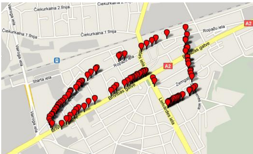
4.5. att Eksperimentos izmantotais 4,4 km garais ceļu tīkla fragments ar manuāli marķētām ceļa seguma bojājumu koordinātēm
