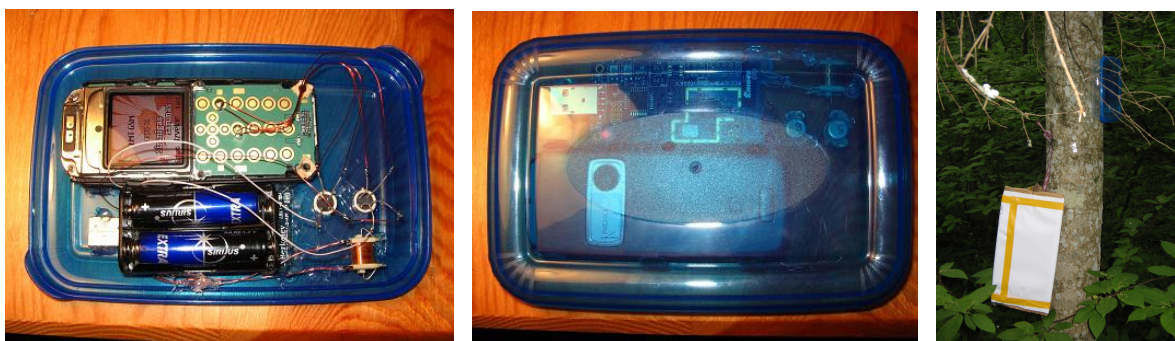
3.7. att. KPMA iekārta uz bezvadu sensoru mezgla Tmote Sky bāzes
