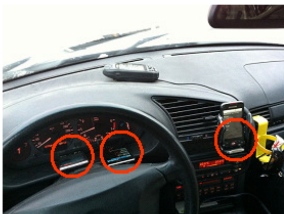
2.4. att. Android viedtālruņi kā mobīlas datu ieguves un apstrādes iekārtas.
