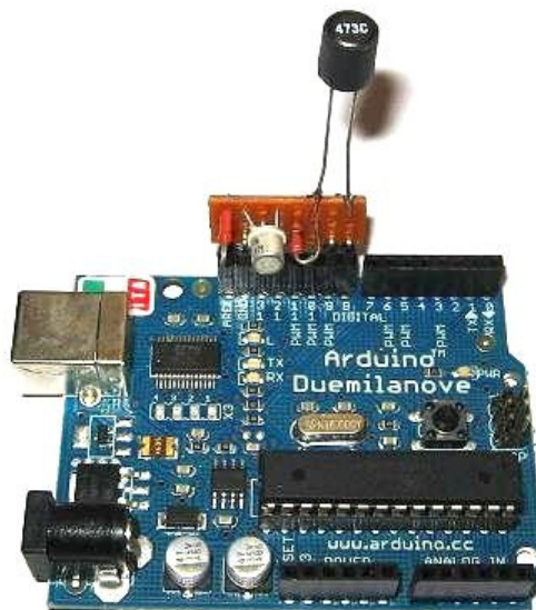
8.5. att. Komponents Arduino Duemilanove, papildināts ar RFID birkas simulēšanas moduli.
