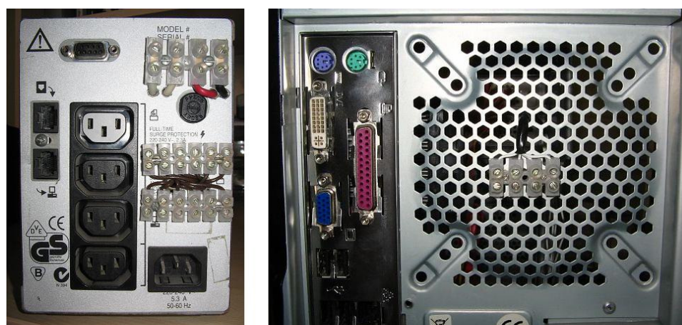
2.14. att. GCDC sacensību transporta līdzekļa UPS bloka un datora modifikācijas.
