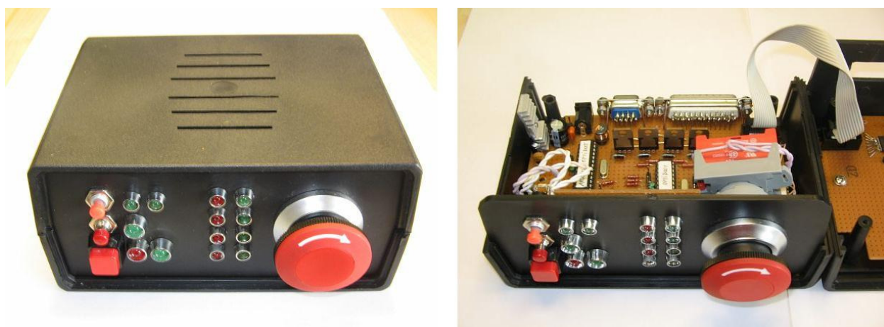
2.13. att. GCDC sacensību transporta līdzekļa akceleratora un bremžu sistēmu vadības, kā arī lietotāja saskarnes modulis
