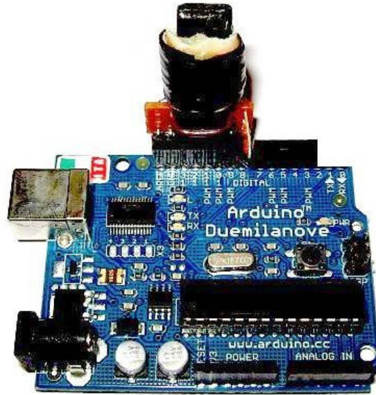
8.4. att. Komponents Arduino Duemilanove, papildināts ar RFID lasītāja simulēšanas moduli.
