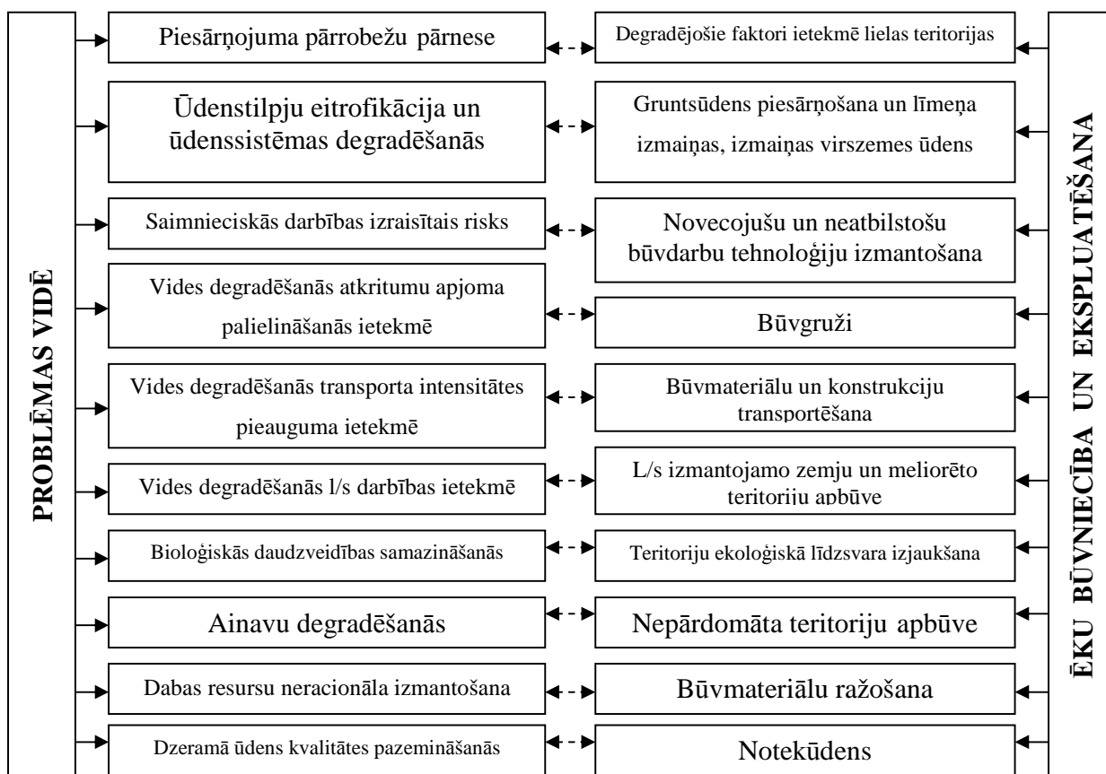
1.13. att. Ēku un inženierbūvju celtniecības un ekspluatēšanas laikā izraisītie nelabvēlīgie un problēmu padziļinošie faktori dabas vidē Latvijā (aut.)
