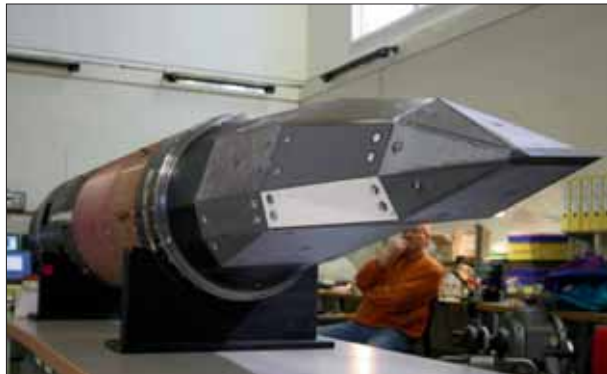
SHEFEX-2 eksperimentālais lidaparāts, uzmontēts uz Brazīlijas izstrādātās suborbitālās nesējraķetes VS-40. DLR attēls
