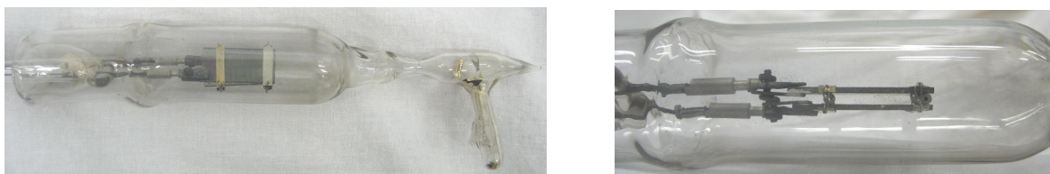
2.2. zīm. Stikla šūna ar elektrodiem un cēzija tvaikiem.
