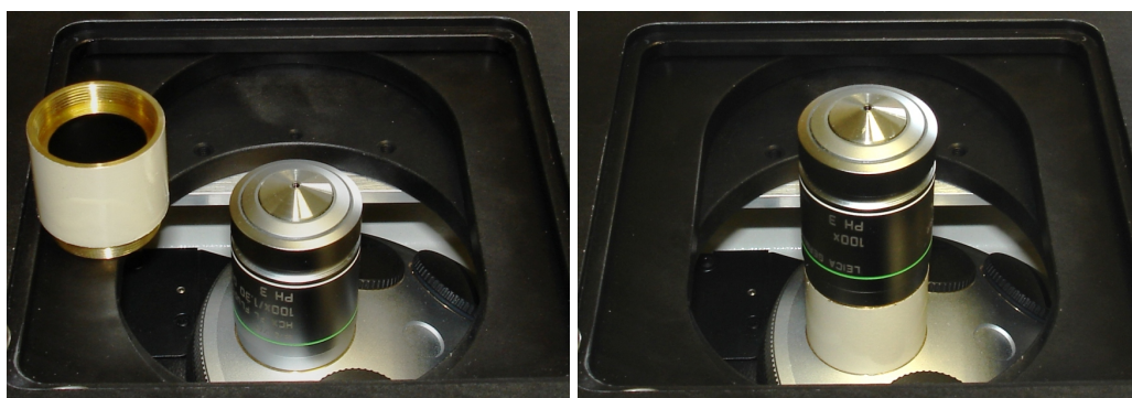
2.13. att.: Mikroskopa objektīva pacelšana.
