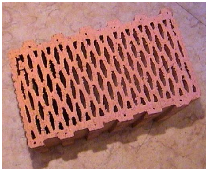
Attēls 2.61. Dobtiem ķieģļiem lieto efektīvo siltuma vadītspēju koeficientu \lambda_{ef} .
