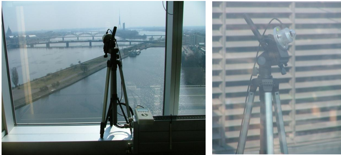
Attēls 2.113. Mērsistēma ar sensoru Hukseflux LP02 un datu uzkrāšanas ierīci Almemo 2290-8 mērījumu laikā.
