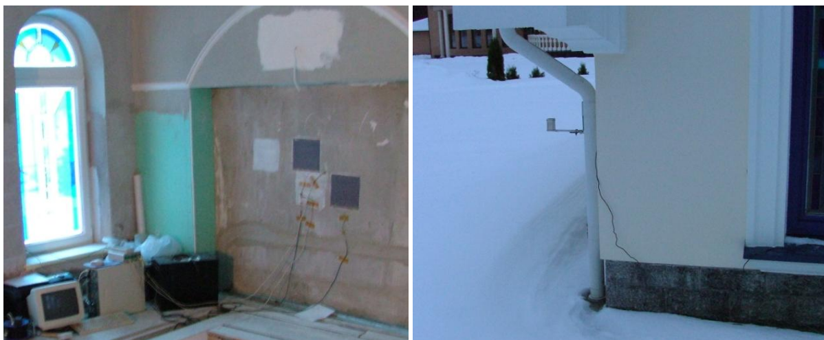
Attēls 2.84. U mērījumi jaunbūves 1. stāvā: siltuma plūsmas un temperatūras sensori iekšpusē (pa kreisi), ārējais temperatūras sensors (pa labi).
