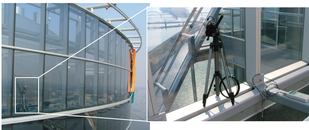
Attēls 2.117. Starojuma intensitātes mērījumi netīrām stikla paketēm uz ēkas jumta.
