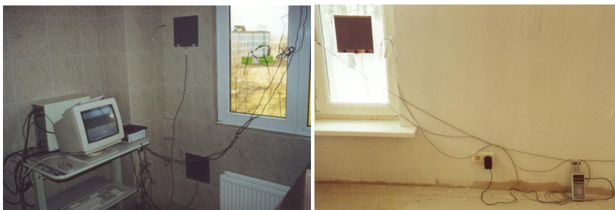
Attēls 2.76. Siltuma plūsmas blīvuma un temperatūras mērījumi. Eksperimentālo datu reģistrēšanai tiek izmantota datorsistēma (pa kreisi) un autonoma iekārta Almemo (pa labi).
