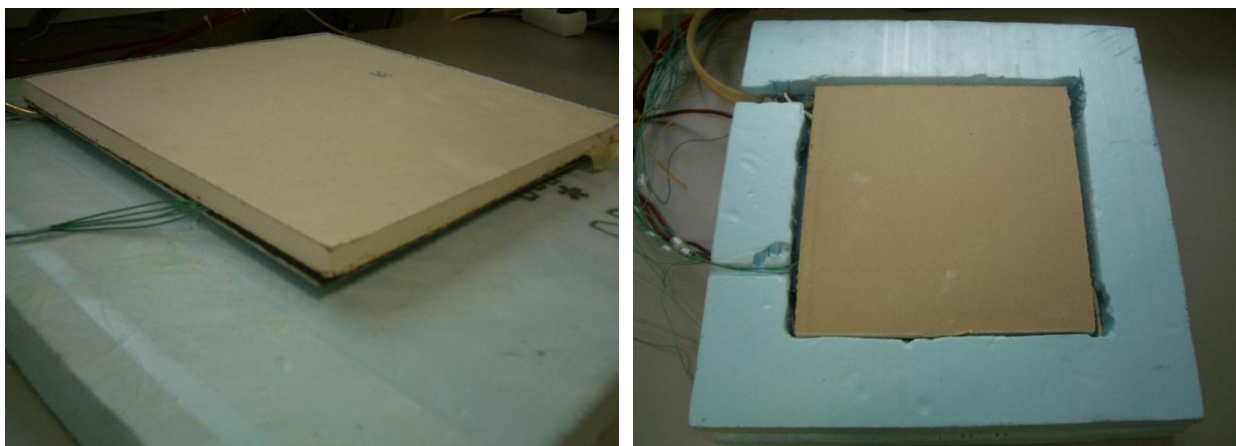
Attēls 2.40. „Karstās plates” iekārtā ievietoti ģipškartona paraugi.
