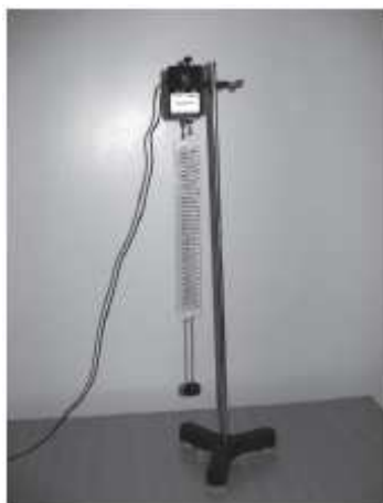
3.4. att. Statīvā iestiprināts spēka sensors un atsperē ar atsvaru.
