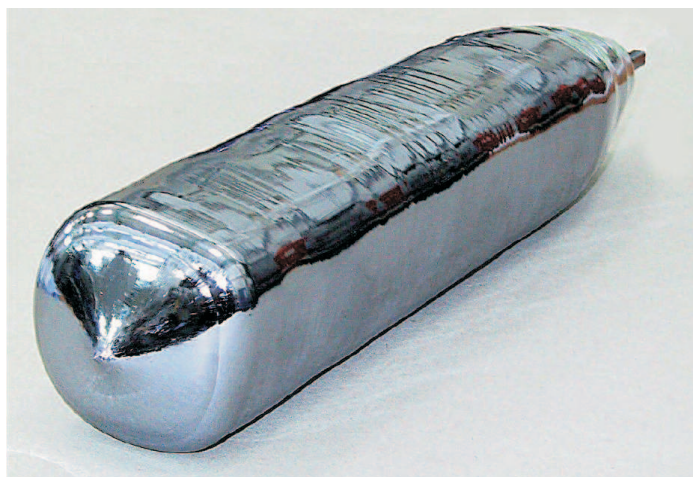
Att. 4.23: Viens no pirmajiem četrkantīgajiem silīcija monokristāliem, kas izaudzēts ar FZ metodi [60]
