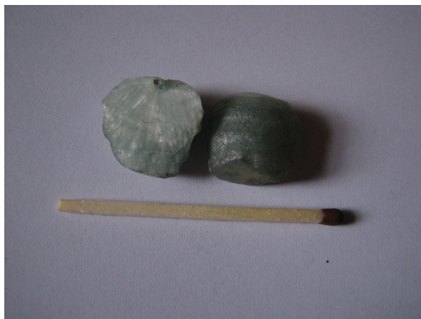
4.5.zīm.: LYF kristāls iegūts audzējot pēc Cz metodes no neatdedzināta kausējuma.
