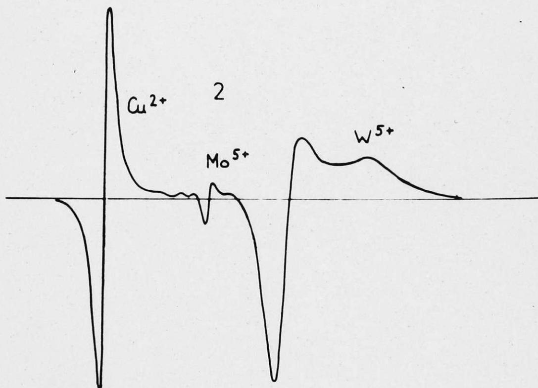
Рис. 4.20. Спектры ЭПР ионов  $W^{5+}$  и  $Mo^{5+}$  в вольфрамфосфатном стекле WA-10 и ионов  $Cu^{2+}$  в  $CuSO_4 \cdot 5H_2O$  при 100 К (1) и 300 К (2).
