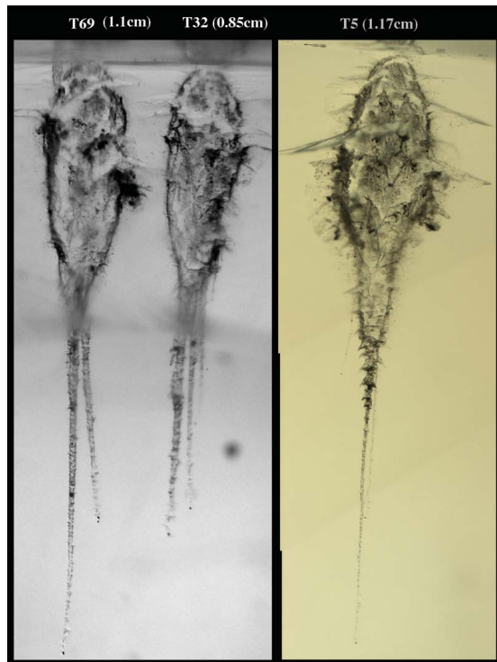
2. att. Vilta 2. komētas daļiņu pēdas jeb treki, tām ietriecoties aerogela blokā.
