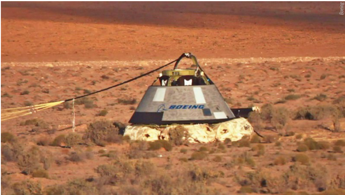
Boeing CST-100 Starliner kapsula nolaidusies uz gaisa spilveniem
