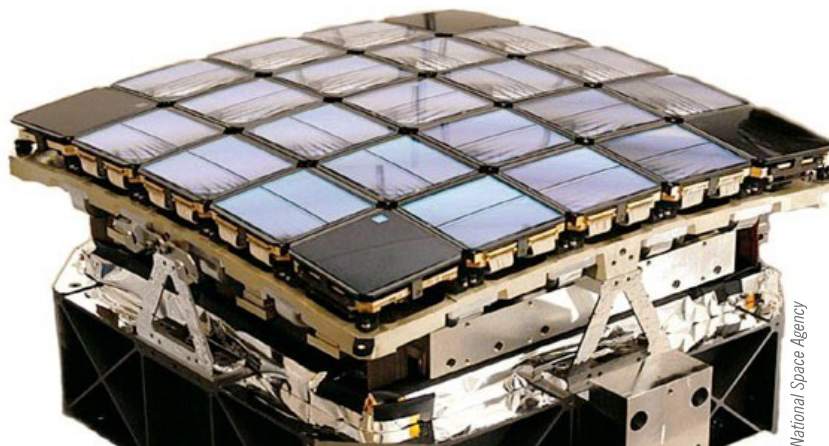
Kosmiskā teleskopa Kepler kameras sensoru modulis
