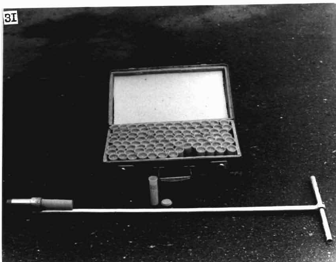
Фото 4. Почвенный бур с надетым на заднее отверстие пробоотбирателя пластмассовым пеналом, пенал с крышкой и чемодан для транспортировки пеналов
