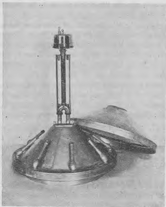
5. uzņ. Dojarenko tipa evapōrometrš.
