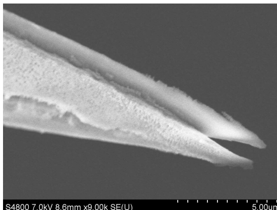
3.23. att. Iegūtā zondes smailes, kuras AAO virsma ir sašķelta, SEM attēls. Zonde veidota līdzstrāvas režīmā \text{H}_2\text{SO}_4 , un \text{H}_3\text{PO}_4 , attiecībā 4,7 un 5,2 mol/L
