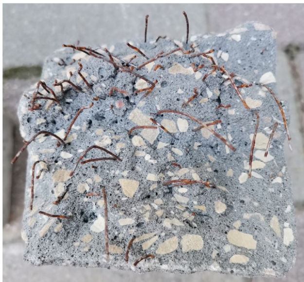
2.2. att. Šķiedru sadalījums parauga tilpumā. (a) Šķiedras vienmērīgi izkliedētas pa visu tilpumu; (b) šķiedras izvietotas tikai noteiktā prizmas slānī.
