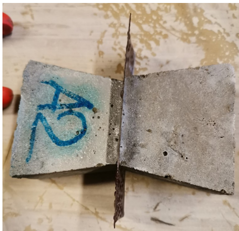
2.7. att. Betona paraugs šķiedru izraušanas testam.
