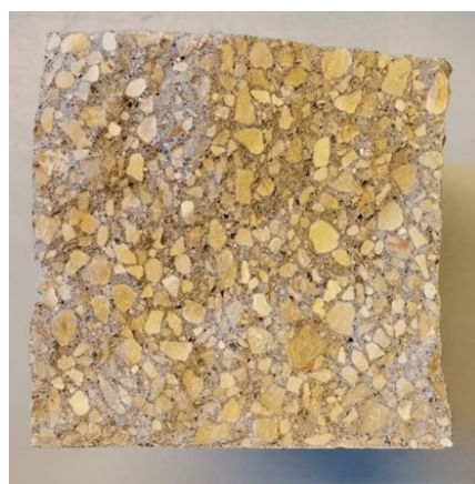
2.4. att. Betona bez šķiedrām prizmas šķērsriezuma piemērs pēc četrpunktu lieces testa.
