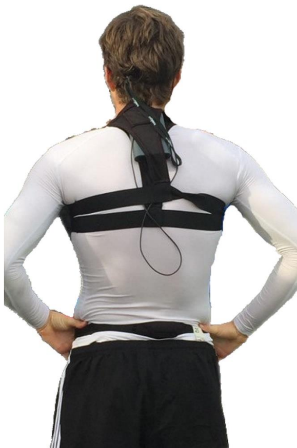
3.2 att., Skatiena sekošanas ierīce “Tobii Pro Glasses 2” piestiprināta pie spēlētāja muguras
