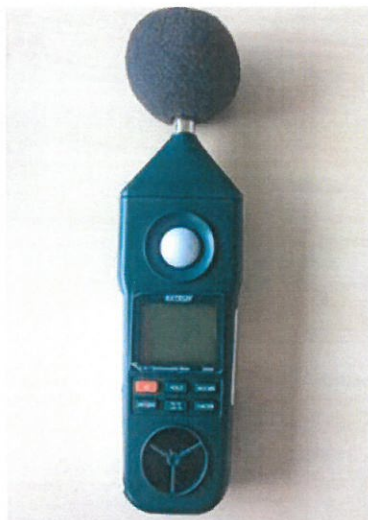
3.27. att. Apgaismojuma mērierīce, Extech instruments 5-in-1 EN300
