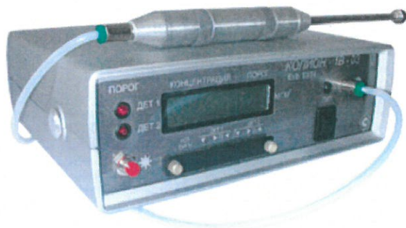
3.24. att. Ierīce ogļūdeņražu mērījumu veikšanai darba vietā KOLOIN
