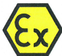
1.4.att. Drošības zīme „Elektroiekārtas un elektroaprīkojums sprādziendrošā izpildījumā”[33]
