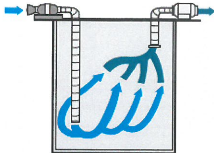
1.28.att. Pareizas un nepareizas ventilācijas ierīkošana slēgtā telpā [25]
