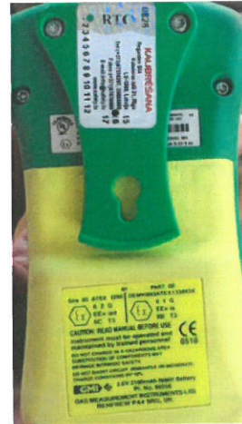
3.26. att. Multifunkcionāls gāzu analizators (aizmugure)
