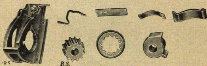
49. zīm. Sakka 4a. klases rindsējmašīnas izmetēja ierīce, izārdīta.
