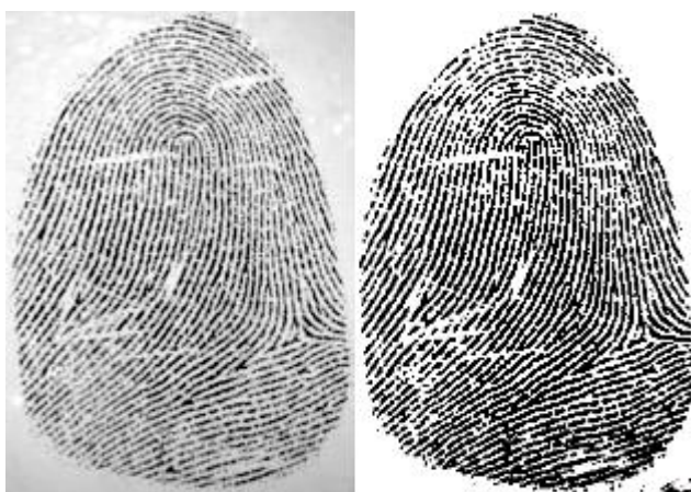
Attēls 4.9. - Normalizētais attēls pa kreisi un tā binārais attēlojums pa labi
