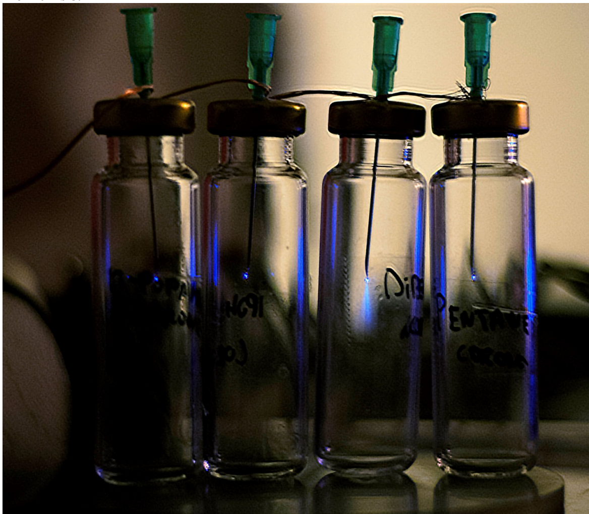
8. att. Koronizlāde dažādu vielu tvaikos (no kreisās uz labo pusi): propān-1-ols, pentān-2-ols, DIPEA, pentāns. Ir novērojams anormāli liels koronizlādes garums DIPEA tvaikos
