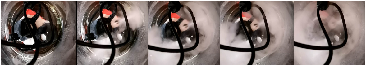
13. att. No kreisās uz labo pusi: ultraskaņas ģeneratora leņķa izvietojums, aerosola veidošana, aerosola sekojoša rotācija
