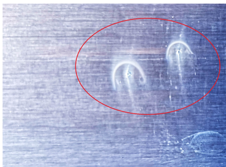
3.3.2. att. Caurumi dielektriskā slānī, izveidojušies lokālas pārkarsēšanas dēļ
