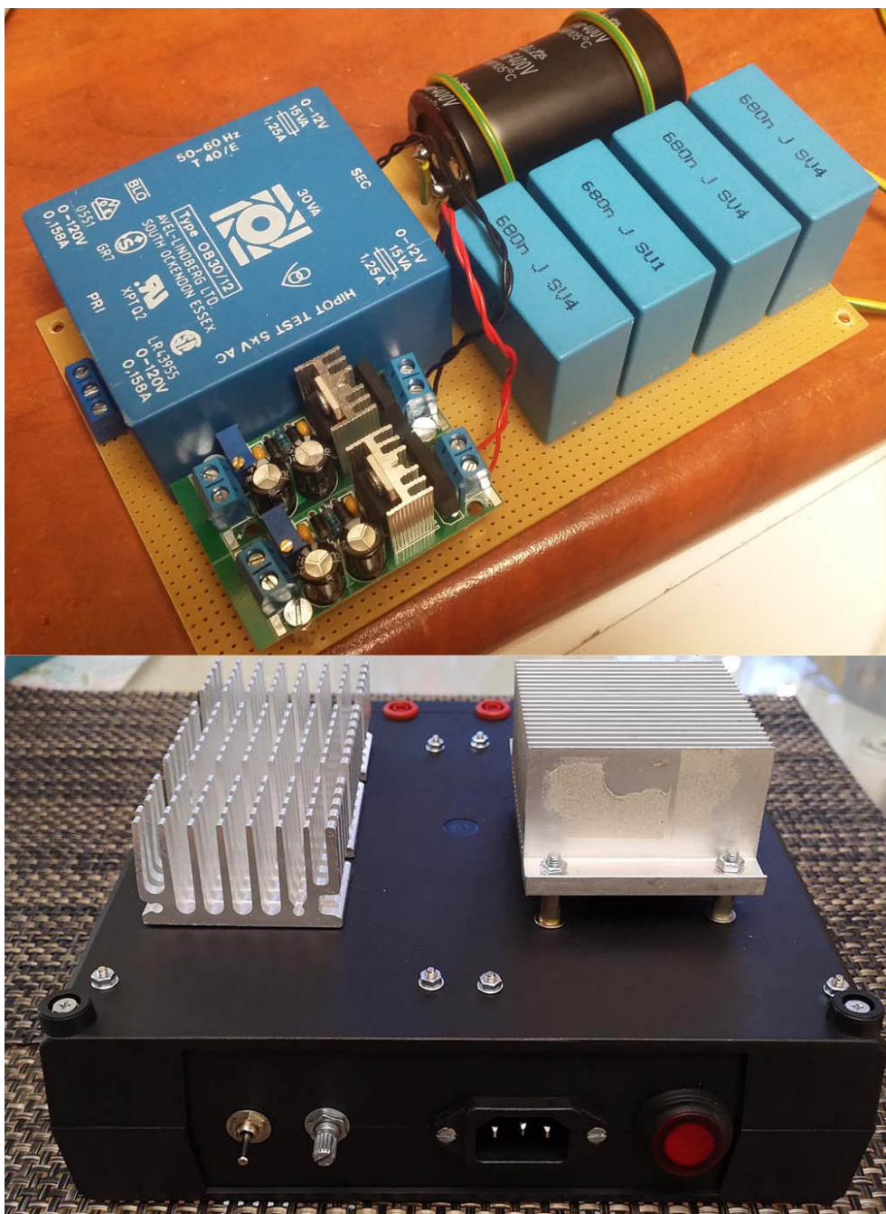
4. att. Pārveidotāja DC sprieguma avoti (bloks Nr. 1. 2.2.2. att.) (zīmējums no augšas), pārveidotāja ārējais izskats (redzamas MOSFET tranzistoru un tilta taisngrieziša radiatori, frekvences regulators, tikla slēdzis).
