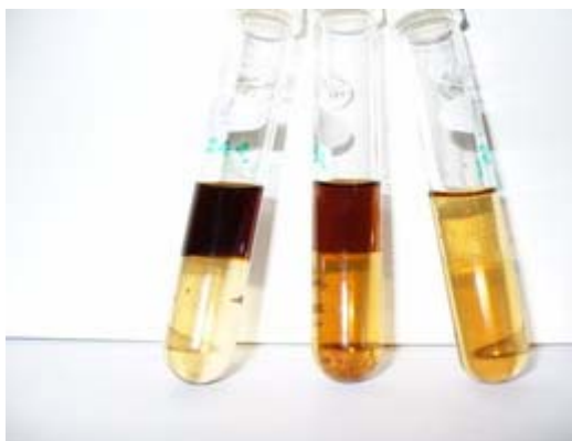
3.1. att. HV šķīduma sadalīšanās hidrofobajā (augšējā) un hidrofilajā (apakšējā) fāzē.
