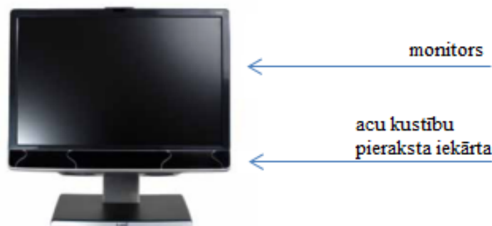
2.1. attēls. Tobii T60XL acu kustību pieraksta iekārta uz monitora [40]
