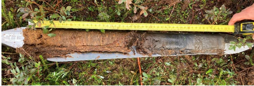
4.6 Attēls 1. profila urbums U 1-1 1,5 līdz 2 m dziļumā, kur 0,27 m kūdras slānis ar koksnes gabaliņiem nomaina minerālgrunts, kas sastāv pelēcīgas aleirītiskas smilts.
