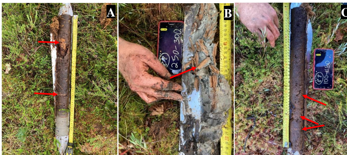
4.5 Attēls 2. profila urbuma U 2-2 3,5 - 4 m dziļumā ar redzamiem koka gabaliņiem kūdrā (līdz 3,9 m), kur tos dziļāk nomaina minerālgrunts ( A ); 8. profila urbuma U 8-8 serde 2,5 - 3 m dziļumā - pirmie 0,06 m veido kūdru ar 60% sadalīšanos pakāpi, ko nomaina minerālgrunts ar koksnes gabaliņiem ( B ) un 8. profila urbuma 8 -8 serde 1 - 1,5 m dziļumā ar identificētu koka gabaliņu slāni kūdrā.
