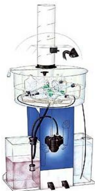
4.2. att. "Drester 3600" krāsu pistoļu mazgāšanas iekārta [28]
