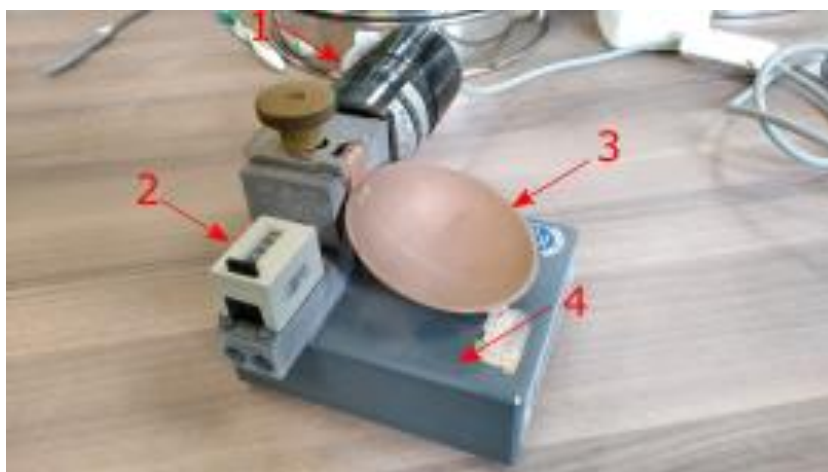
2.4. attēls. Kasagrandes iekārta. Apzīmējumi: 1. motors; 2. sitienu skaitītājs; 3. bļodiņa; 4. gumijas bloks (autora foto)
