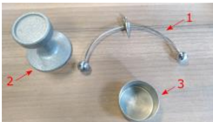
2.6. attēls. Balansējošais Vasiljeva konuss. Apzīmējumi: 1. balansējošais Vasiljeva konuss; 2. statīvs; 3. trauciņš (autora foto)
