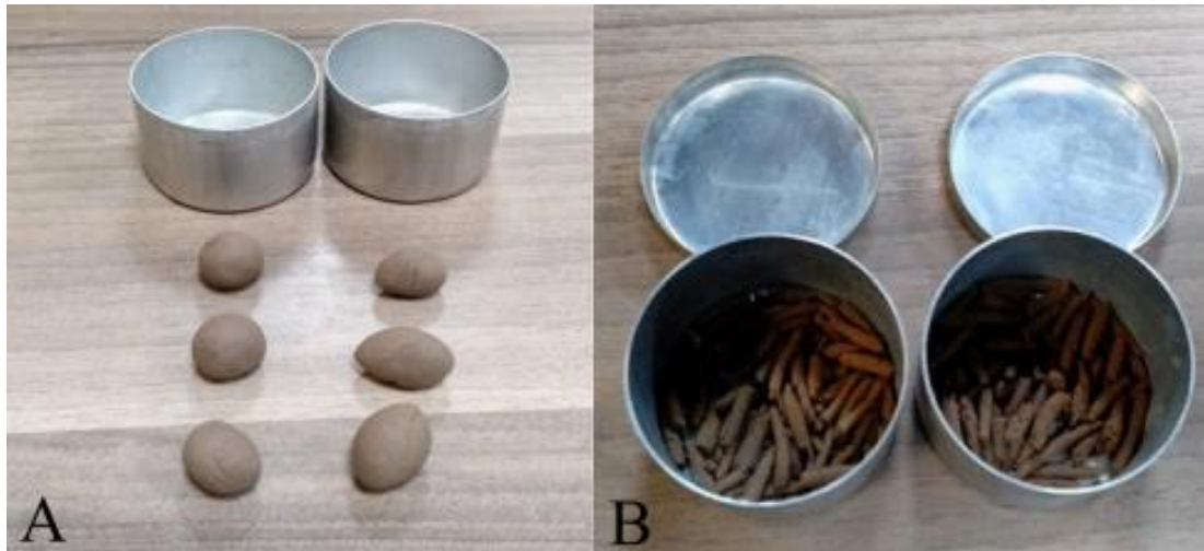
4.5. attēls. Plastiskuma robežas noteikšana. A. Sadalītais paraugs plastiskuma robežas noteikšanai; B. Plastiskuma robežu sasniegušais grunts paraugs (autora foto)
