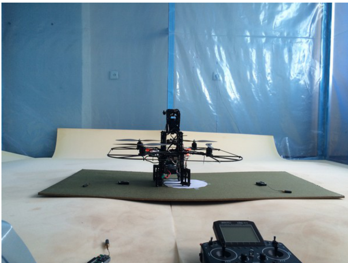
19. att.: AscTec Pelican kvadrotors un IQRF bezvadu sensoru tīkls iekārtotajā testa telpā
