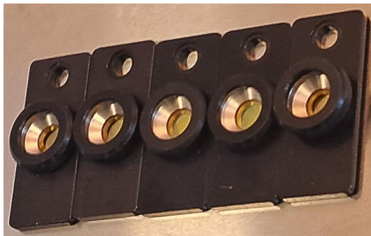
2.9.att. Cinka selenīda virsma (logs) iestiprināts kompresijas šūnā [Foto: Sintija Bušmane]
