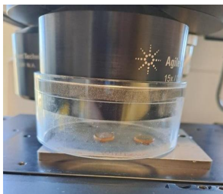
2.10.att. Parauga sagatavošana darbam ar mikro-FTIR iekārtu [Foto: Sintija Bušmane]
