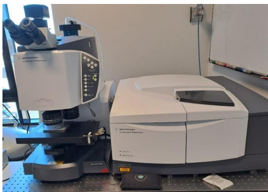
2.8.att. Paraugu analīzei izmantotā FPA- \mu FTIR attēlveidošanas spektroskopijas iekārta [Foto: Sintija Bušmane]
