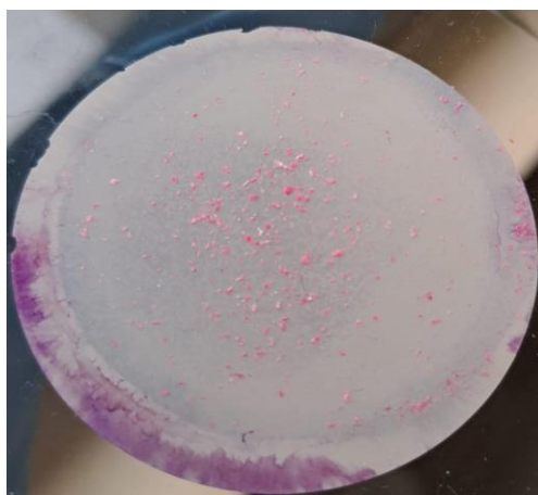
2.14.att. Testa paraugs ar zināmu polimēra veidu – PET - veicot iekrāsošanu ar Nīlas sarkano krāsvielu [Foto: Sintija Bušmane]
