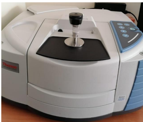
2.15.att. Mikroplastmasas identificēšanā, izmantotā ATR-FTIR iekārta Thermo Fisher Scientific Nicolet iS20 [8]
