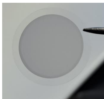
2.6.att. Paraugu filtrēšanai izmantotais alumīnija (III) oksīda filtrs ar apkārt filtram esošo polietilēna gredzenu [Foto: Sintija Bušmane]
