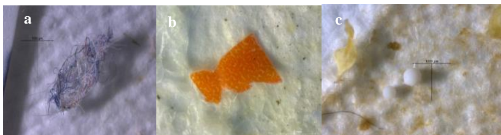
1.3.att. Biežāk atrasto mikroplastmasas daļiņu formas: a – šķiedras, b – fragments, c - lodīte [Foto: Marta Barone]
