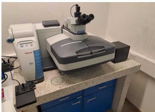
2.4.att. Mikroplastmasas polimēru identificēšanai izmantotā \mu -Raman iekārta [Foto: Sintija Bušmane]
