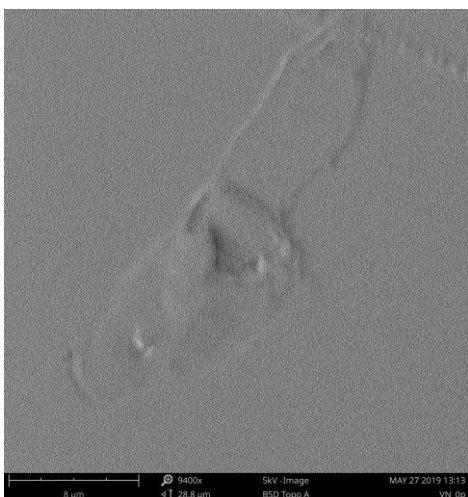
3.7. att. SPĒĒK membrānas ar 0% ZrO 2 saturu virsmas topogrāfija
