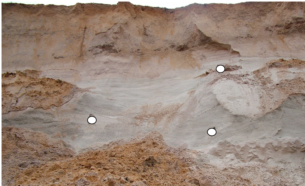
5.1.2.3. attēls. Atsegums Bajārkalnu karjera sienā, kur atzīmētas slāņu saguluma elementu mērījuma vietas (autora fotogrāfija).
