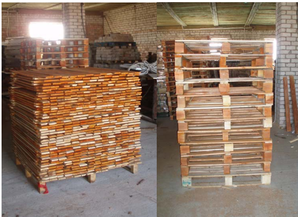
7.2.att. Taras dēļi un no tiem gatavotie paliktņi
