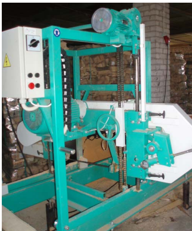
7.8.att. Lentzāģis LTZ 60 paliktņu un taras dēļu zāģēšanai
