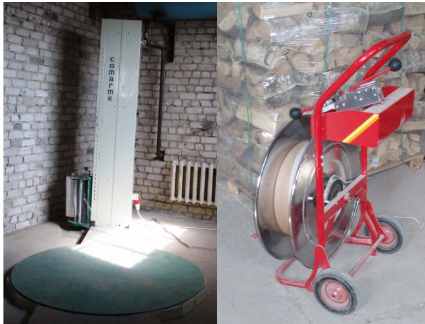
7.9.att. Paliktņu ietinamais aparāts un stīpojamais aparāts
