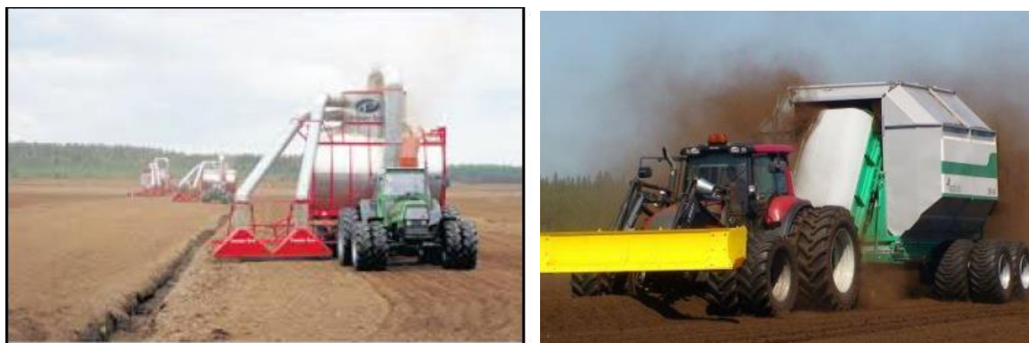
1.2. attēls. Frēzkūdras ieguve izmantojot pneimatiskos (kreisā puse) un mehāniskos savācējus (labā puse) (avots: Nīcgales IVN 2017; Kalnasalas IVN 2017).
