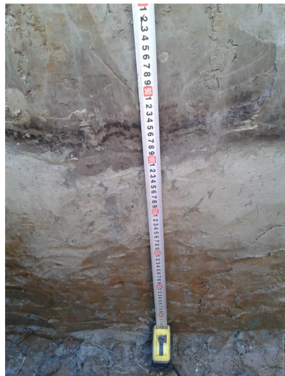
3.6.2. attēls. Blīvs, viendabīgs gleja horizonts (parauglaukums Nr.5) (foto: A.Bebriša).
