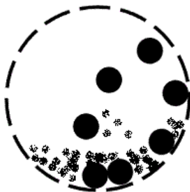
3.1. attēls. Mehāniskās sakausēšanas procesa shematisks atainojums
