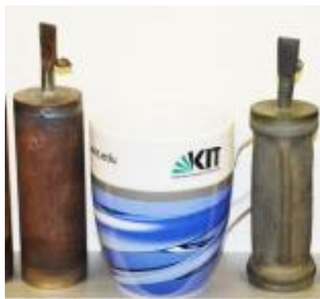
3.2. attēls. Pirms un pēc izostatiskās presēšanas cilindra izskats
