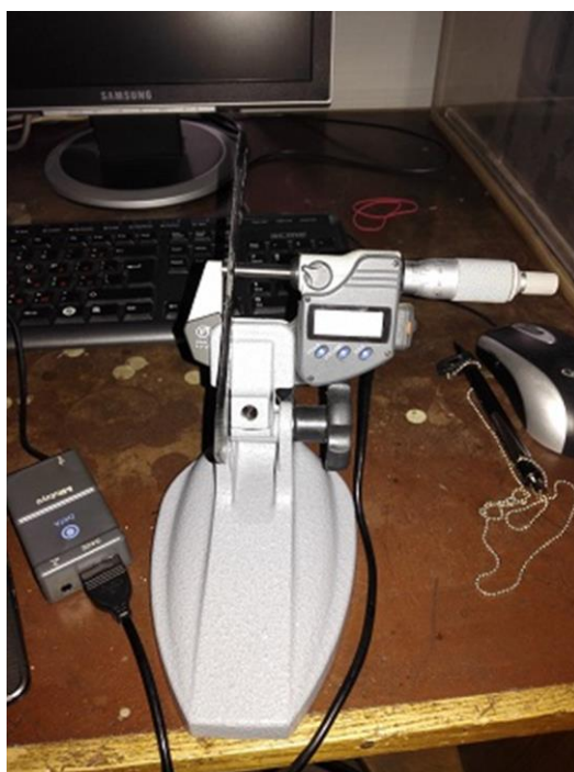
2.7. attēls. Parauga biezuma noteikšana (autora foto).
