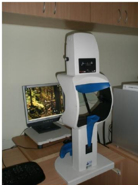
2.1. att. Datu iegūšanai izmantotā acu kustību pieraksta iekārta sānskatā ar tai priekšā novietoto monitoru, kurā tiek rādīti eksperimentam nepieciešamie stimuli.
