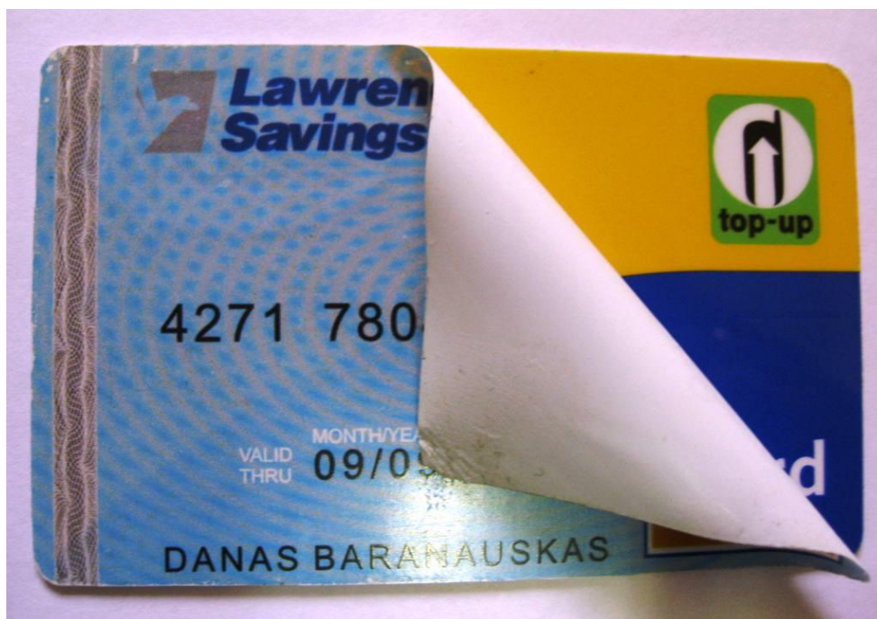
Attēls Nr.3. Ar aplīmēšanas metodi izgatavots kartes plastikāta viltojums (avots: Lietuvas Republikas valsts policija, 2009.gads)
