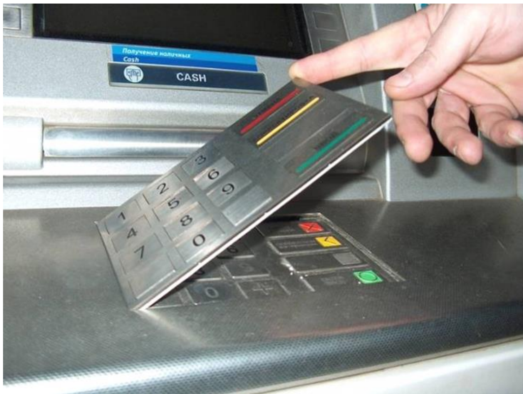
Attēls Nr.10. Bankomāta viltus klaviatūra maksājumu karšu PIN kodu iegūšanai 255
