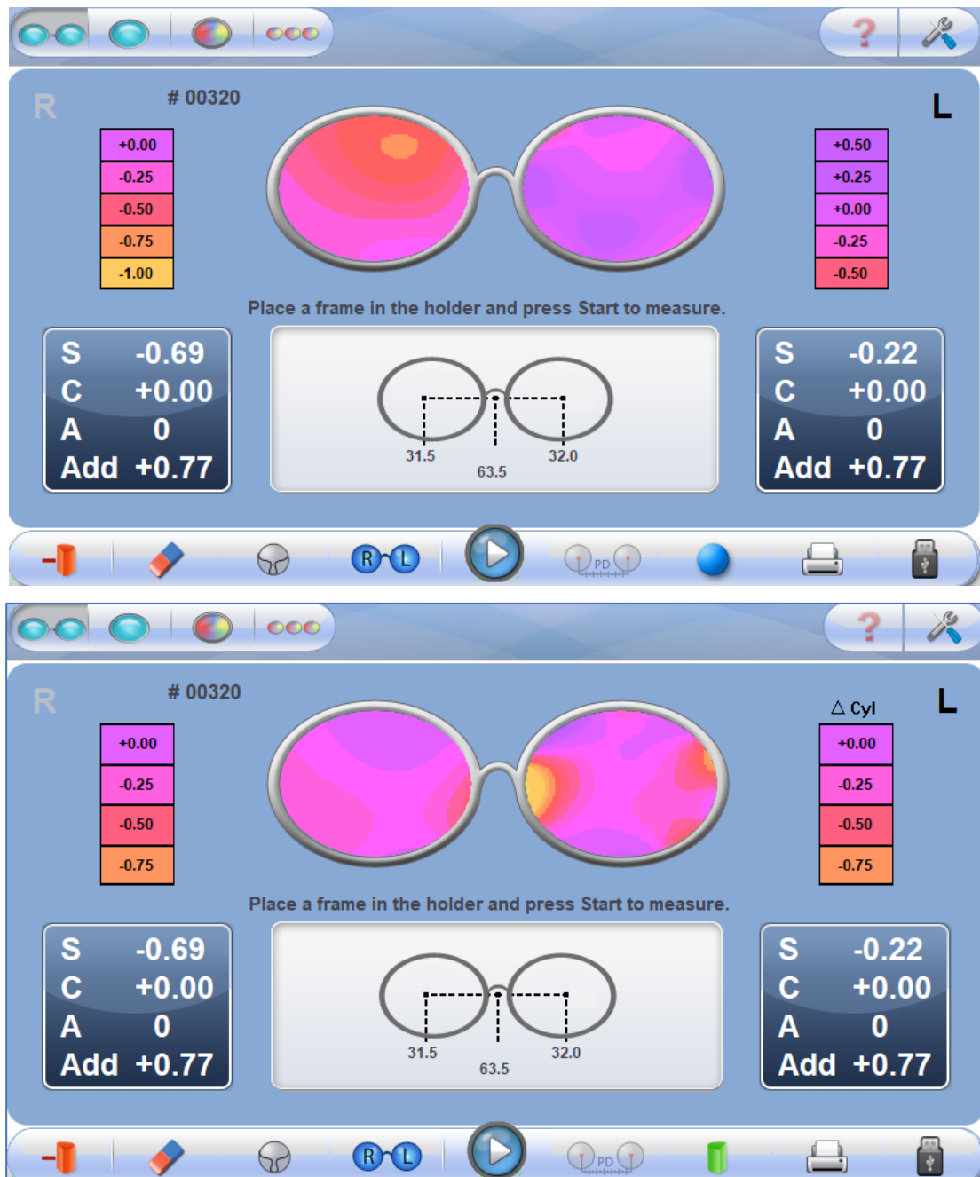
3.10. att. Essilor Eyezen 0,6 sfērisko (augšā) un cilindrisko (lejā) kropļojumu komponentu sadalījums (S – sfēriskās korekcijas stiprums, C – cilindriskās korekcijas stiprums, A – cilindra ass virziens, Add – aditīva lielums).
