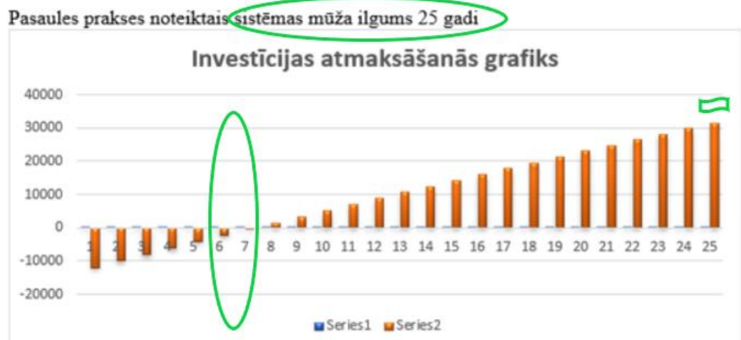
3.19.att. Investīcija saules enerģijas ar saules paneļiem projekta realizācijai Avots: Autores veidots pēc aprēķina informācijas 3.pielikumā
