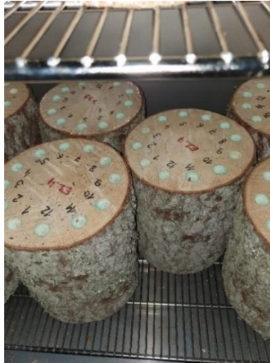
15. attēls. Bluķīšu novietojums klimata kamerā (A. Bēčas foto). Figure 15. Billet placement in climate chamber (photo by A. Bēča).
