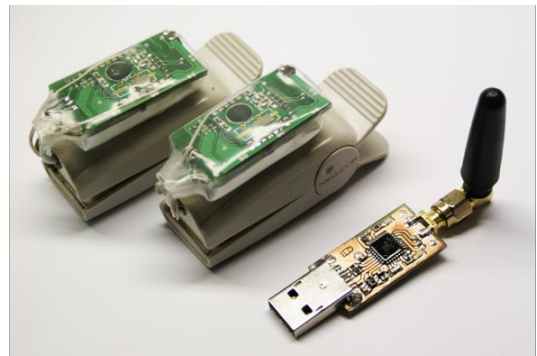
42. att. PPG signāls no bezvadu uzpirksteņa un izveidotā bezvadu PPG uzpirksteņa (II versija) un USB uztvērēja kopskats.
