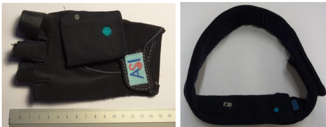
52. att. Vieda cimda un pieres apsēja prototipa kopskats (ar integrētu elektronisko shēmu).
