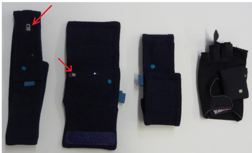
53. att. Izstrādātie „viedā apģērba” prototipi, no kreisās puses – pieres lente, šalle, plaukstu locītavas lente, cimds, ar bultiņu norādītas PPG sensoru vietas.
