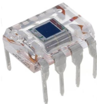
38. att. PPG uzpirksteņa sensora fotodiode ar iebūvētu pastiprinātāju OPT101 [46].
