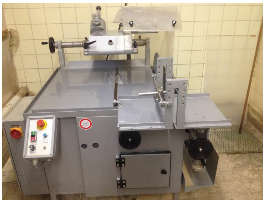
4.4. attēls. Zāģēšanas agregāts Apparatebau GmbH Conrad D-38678 ar dimanta ripu (autora foto, 2014)
