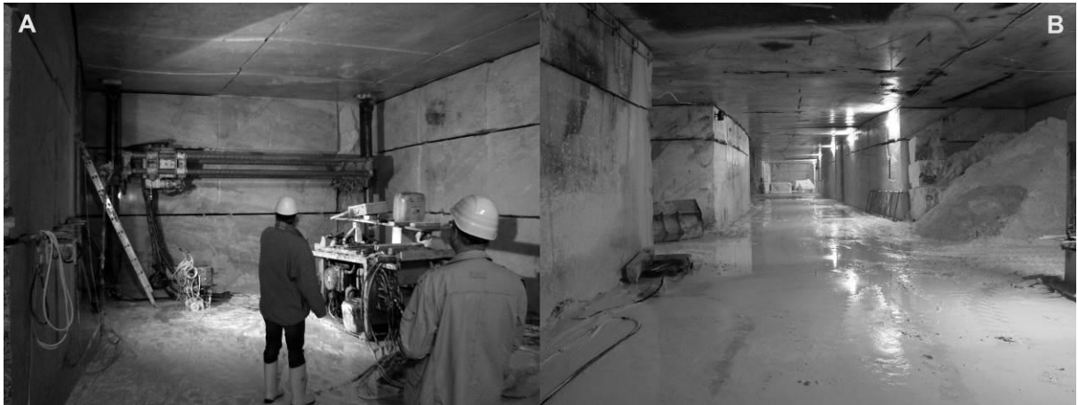
4.3. attēls. A – Šteindlas pazemes tipa atradnes kaļķakmeņu blokveida zāģēšanas iekārta 2013. gada augustā; B – Šteindlas pazemes tipa atradnes štolles 2013. gada augustā (Markusa Mozera materiāli).
