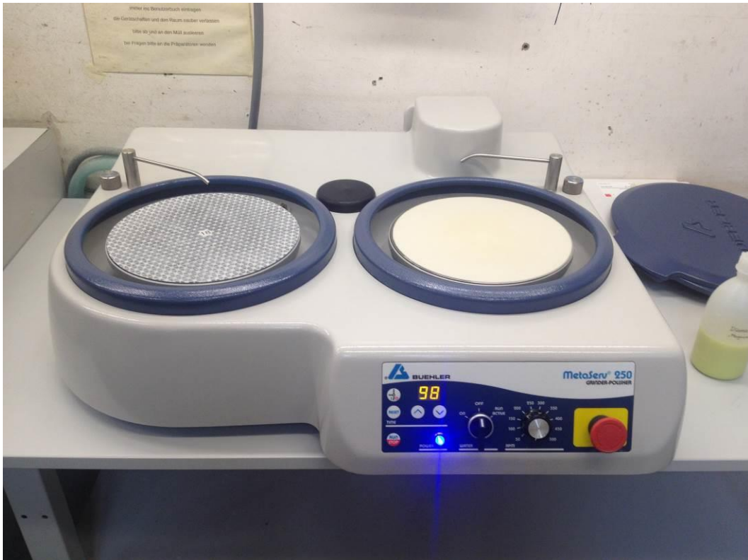
4.8. attēls. Slīpēšanas un pulēšanas agregāts Buehler MetaServ 250 ar divām slīpēšanas ripām (autora foto, 2014)
