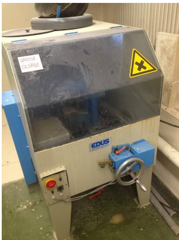
4.5. attēls. Automatizētais zāģēšanas agregāts EDUS Schleiftechnik GS 600A ar dimanta ripu (autora foto, 2014)
