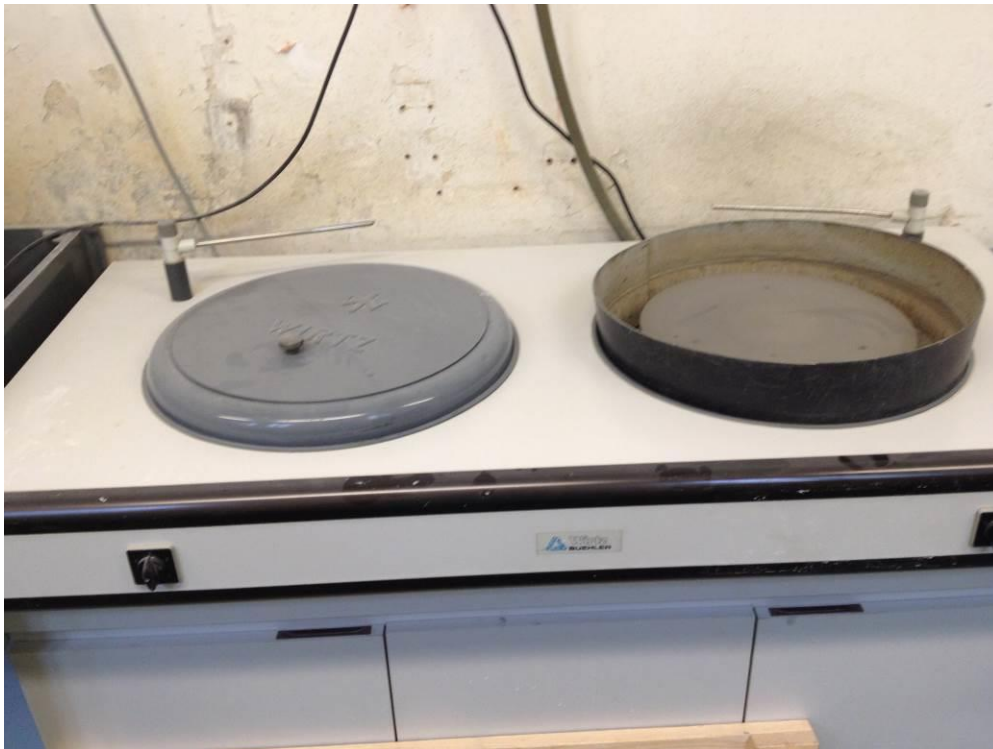
4.7. attēls. Slīpēšanas agregāts Wirtz Buehler 100 ar divām slīpēšanas ripām (autora foto, 2014)
