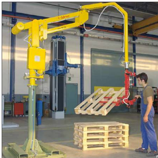
4.4. att. Palešu celšanas iekārta [131]
