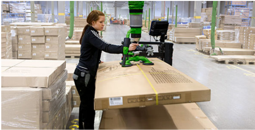
4.5. att. Objektu pārvietošana ar vakuuma pacelāju [132]
