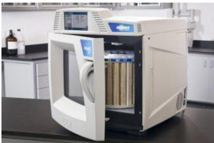
2.1. att. Mikroviļņu krāsns CEM Mars 6
