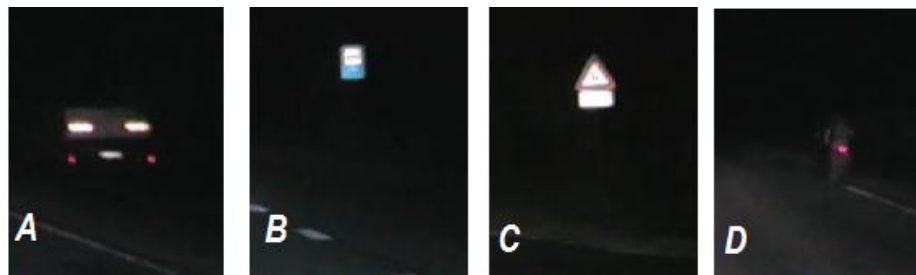
2.8. att. RR objektu piemēri eksperimenta video. A - ceļa malā novietotas smagās automašīnas brīdinošie RR; B,C – ceļa zīmes; D – velosipēda RR
