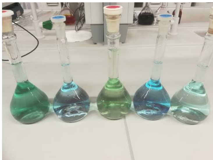
3.19. Att. Sagatavotie paraugu šķīdumi Fe (III) un (II) jonu daudzuma noteikšanai spirulīnas paraugu ūdens šķīdumā, izmantojot fotometrijas metodi
