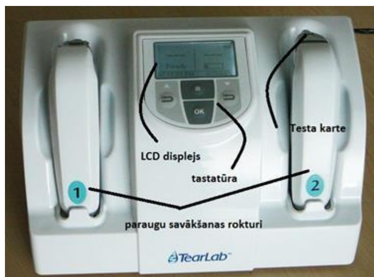
2.1. attēls. TearLab pārnēsājamā ierīce asaru osmolaritātes mērīšanai. Ir divi parauga savākšanas rokturi, kuros ievieto vienreiz lietojamu testa karti, ir LCD displejs un tastatūra.
