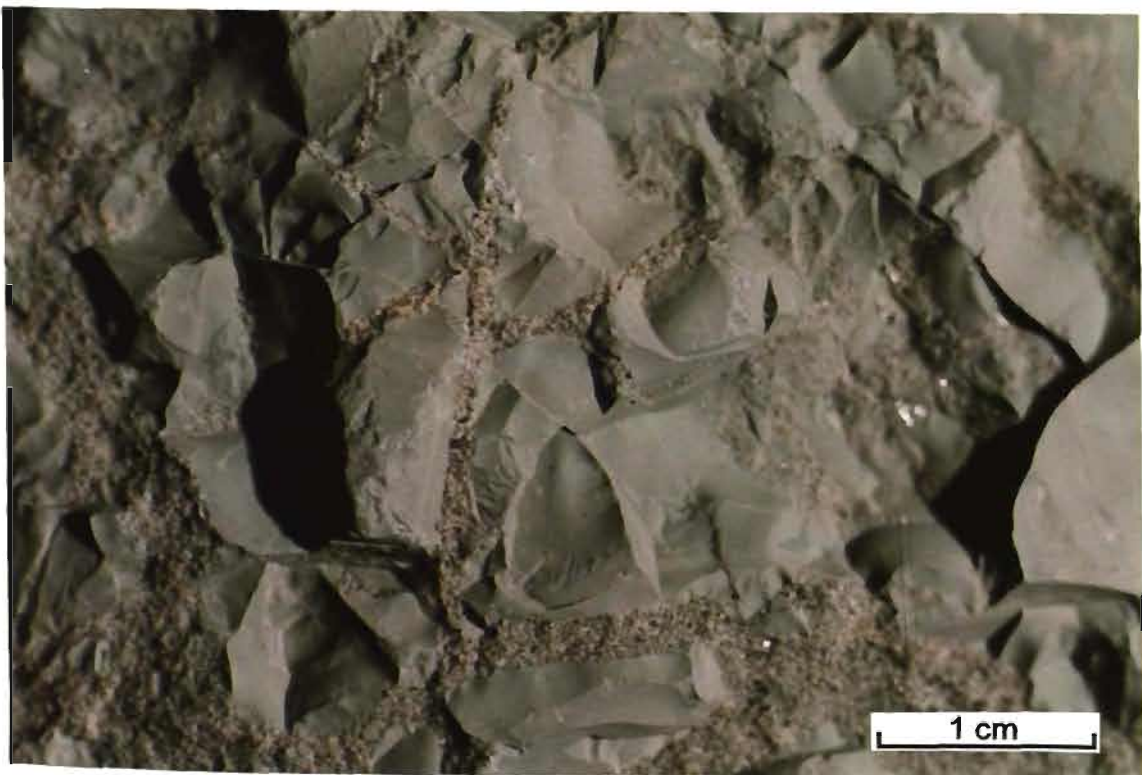
22. att. Zaļganpelēks domerīts ar žūšanas plaisām, ko aizpilda aleirītiska un vidēj-rupjgraudaina smilts. Plaisas krasi nodalās no domerīta pamatmasas, kurā smilti praktiski nesastop. 103. Šķaunes urbums, 399,3 m dziļums, vidusdevona Rēzeknes svīta.
