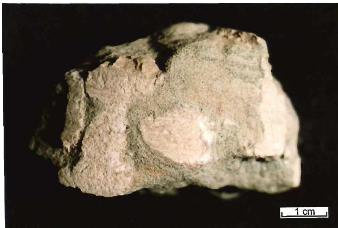
14. att. Zaļganpelēks smalk-vidējgraudains smilšakmens ar dūņēdāju ejām, kuras sastāv no bīva dolomīta ar nelielu drupu graudu saturu. Redzama šo organismu veidojumu caurulveida forma. 103. Šķaunes urbums, 402,5 m dziļums, vidusdevona Rēzeknes svīta.
