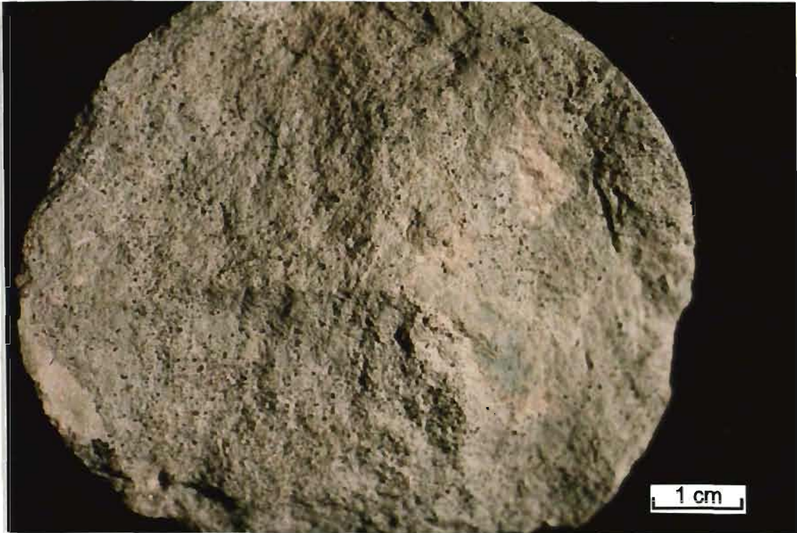
19. att. Zaļganpelēkais domerīts ar nevienmērīgi izkliedētas vidēj-rupjgraudainas smilts piejaukumu. 15. Ludzas urbums, 447,5 m dziļums, vidusdevona Rēzeknes svīta (pie kontakta ar silūra nogulumiem).
