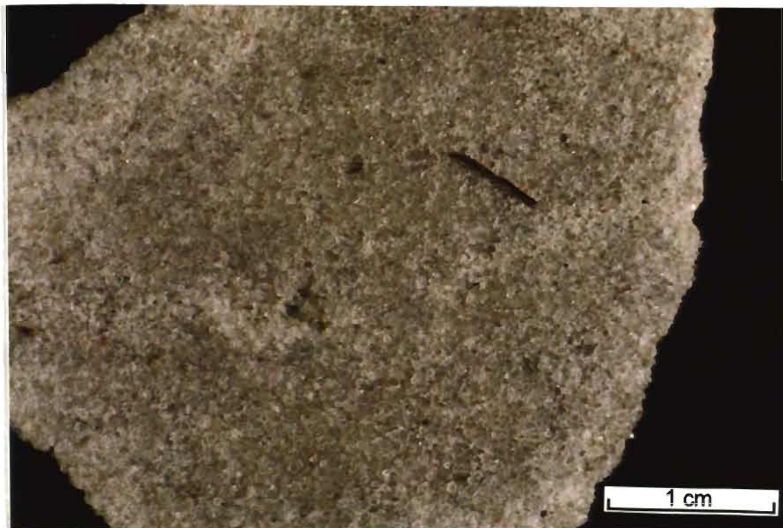
13. att. Vidēj-rupjgraudains smilšakmens ar poikilotopisku ģipša cementu. Redzama ieža labā šķirotība un tumšo minerālu neliels saturs. Brūnā iegarenā plēksnīte - zivs kauls. 103. Šķaunes urbums, 400,5 m dziļums, vidusdevona Rēzeknes svīta.
