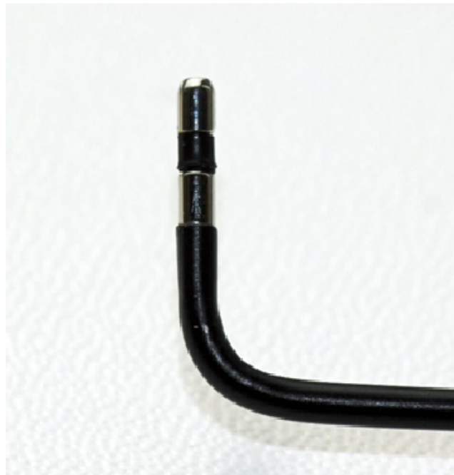
1.6.attēls Bipolāra kriptolīzes elektroda aktīvā daļa (Vogt et al, 2017, "Development and clinical evaluation of bipolar radiofrequency crytolysis")
