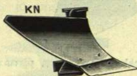
17. zīm. Marka K N, stāva vērstuve ar augstu stāvu, drupanai, bet līpīgai zemei.
