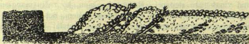
11. zīm. Viengraudsakārtas (pa kreisi) pārvēršanās pinkuļsakārtā (pa labi).
