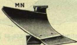
18. zīm. Mārka M N, vidējstāva vērstuve ar augstu stāvu, vidējsmagām zemēm.
