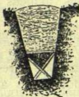
10. zīm. Žagardrena, kuņā žagaru bunte balstās uz staklītēm.
